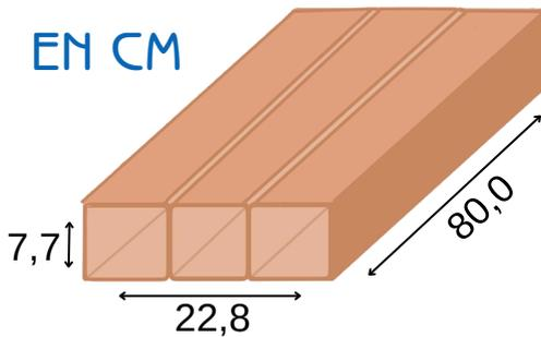
El bloquelón Santafé está hecho de arcilla y es un ladrillo alargado de alta resistencia. Se utiliza en proyectos de construcción para remodelar, ampliar viviendas, locales y bodegas.
